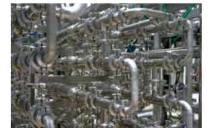
3重管チューブ 高粘度液でも少ないホールド量で均一殺菌が可能。
