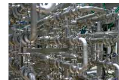
3重管チューブ 高粘度液でも少ないホールド量で均一殺菌が可能。
